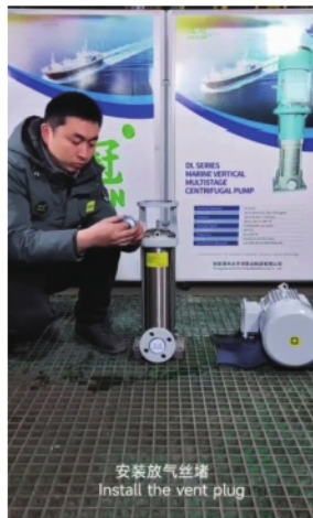
安装放气丝堵 Install the vent plug
