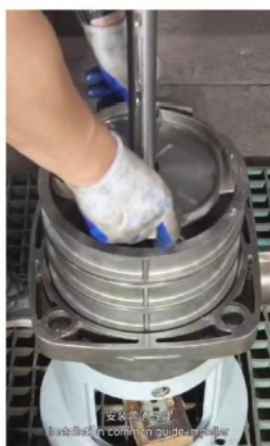
安装普通导叶 Installation common guide impeller.
