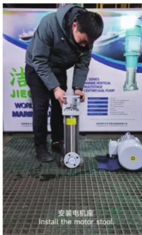
安装电机座 Install the motor stool
