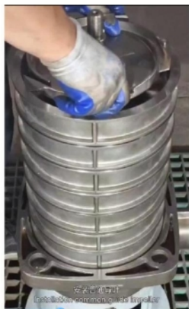
安装普通导叶 Installation common guide impeller.
