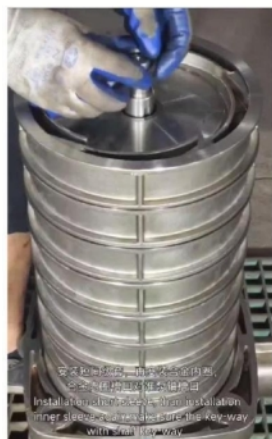
安装短间级套，再安装合金内圈，合金内圈槽口对准泵轴槽口。
