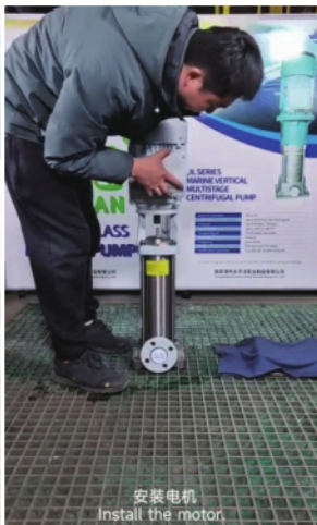
安装电机 Install the motor
