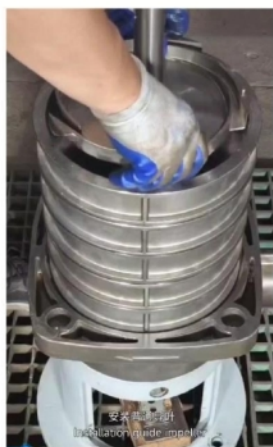
安装普通导叶 Installation guide impeller.
