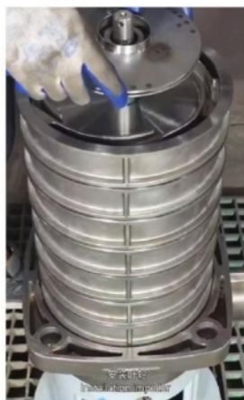
安装叶轮 Installation impeller.
