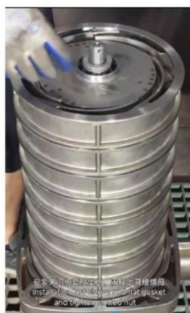
安装末间级套和垫片，再拧上开槽螺母
