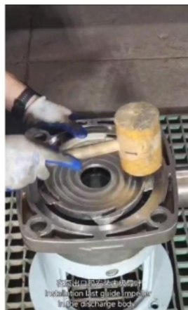
在泵出口段安装末级导叶
