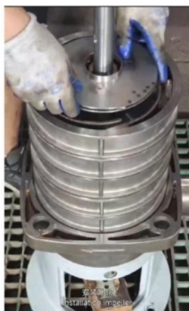
安装叶轮 Installation impeller.
