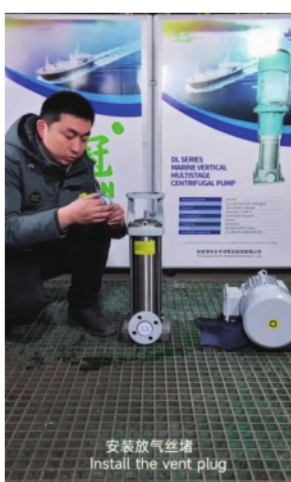
安装放气丝堵 Install the vent plug
