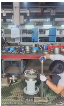
在泵轴上安装平衡鼓
