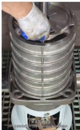
安装普通导叶 Installation common guide impeller.
