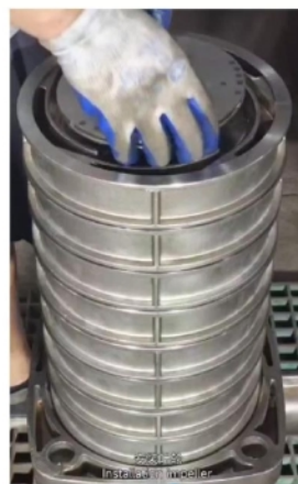
安装叶轮 Installation impeller
