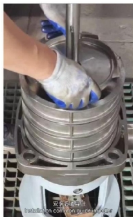
安装普通导叶 Installation common guide impeller.
