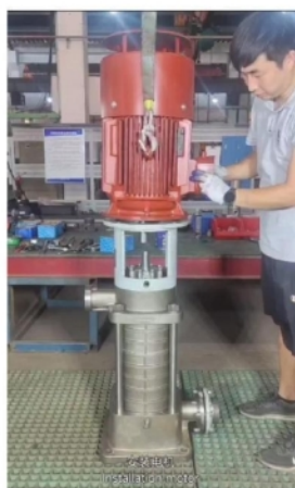
安装电机 Installation motor.
