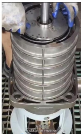
安装叶轮 Installation impeller.
