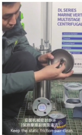
安装机械密封静环(保持摩擦副表面清洁) Keep the static friction pair clean.
