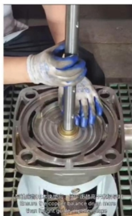
泵轴底部用木块垫高， 使平衡鼓高于末级导叶
