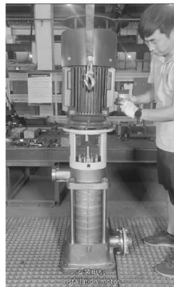
安装电机 Installation motor.
