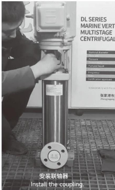
安装联轴器 Install the coupling.
