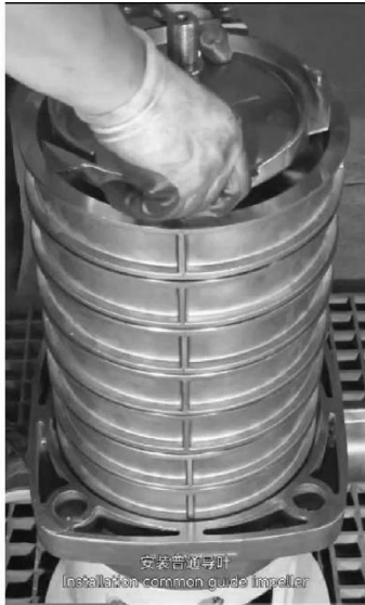
安装普通导叶 Installation common guide impeller.
