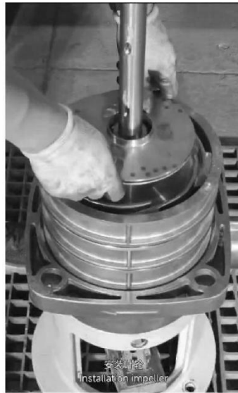
安装叶轮 Installation impeller.
