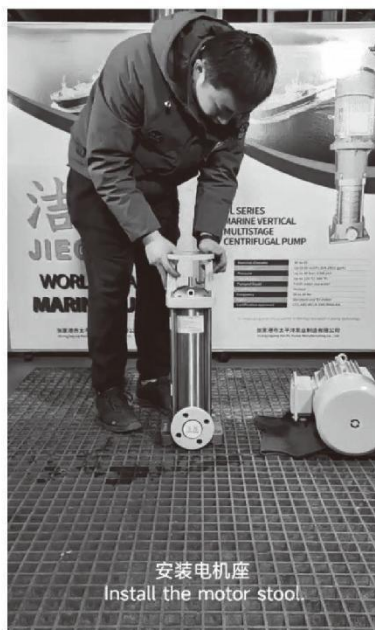
安装电机座 Install the motor stool
