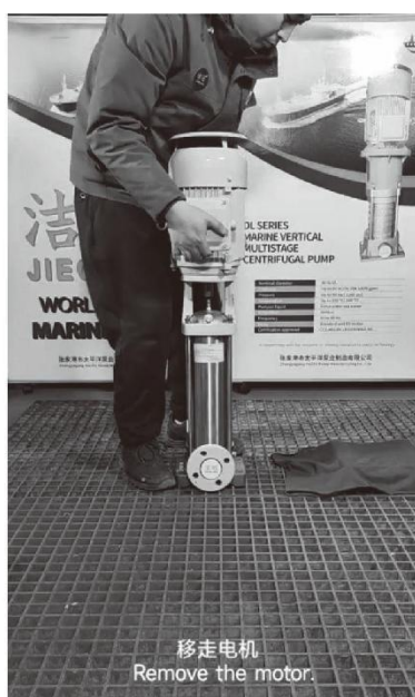
移走电机 Remove the motor.
