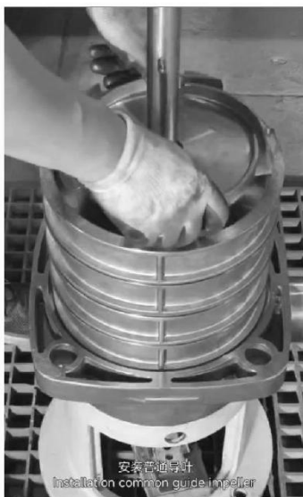
安装普通导叶 Installation common guide impeller.
