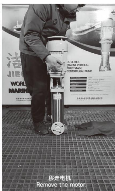
移走电机 Remove the motor.
