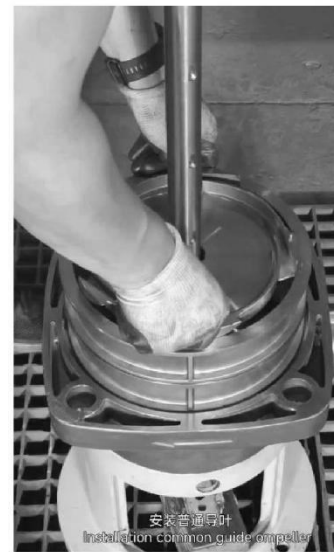
安装普通导叶。 Installation common guide impeller.
