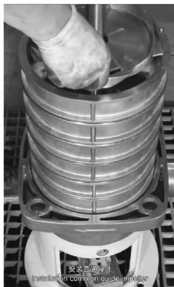
安装普通导叶 Installation common guide impeller.
