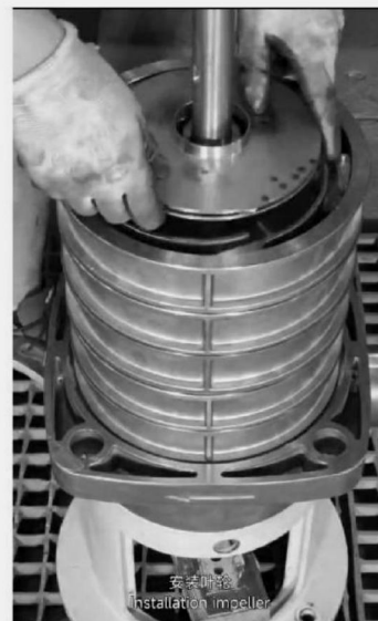
安装叶轮 Installation impeller.
