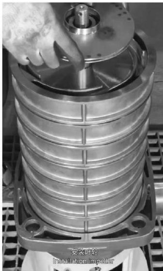
安装叶轮 Installation impeller.
