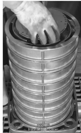
安装叶轮 Installation impeller
